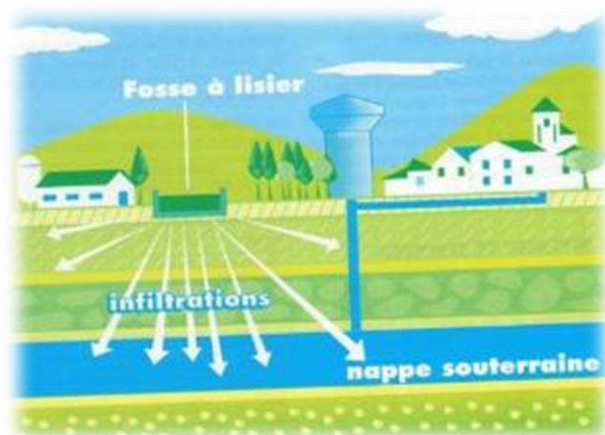
Figure 7. Contamination des eaux souterraines par une fosse à lisier fissurée
